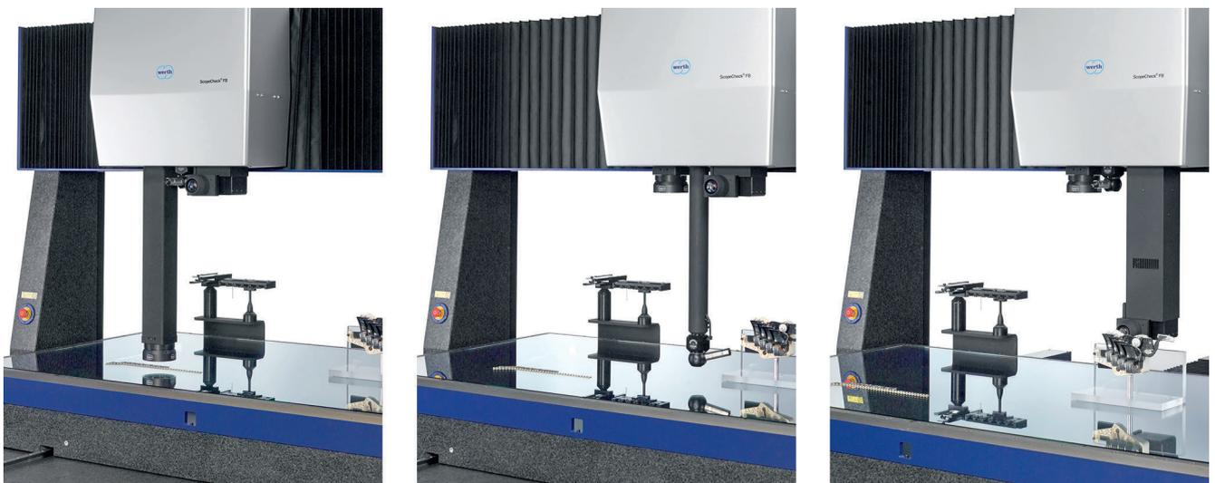
Bild 1. Multisensor-Messung mit Bildverarbeitung und Werth Zoom (links), konventionellem Taster am Dreh-Schwenk-Gelenk (Mitte) und Chromatic Focus Line Sensor (rechts) am ScopeCheck FB © Werth Messtechnik
