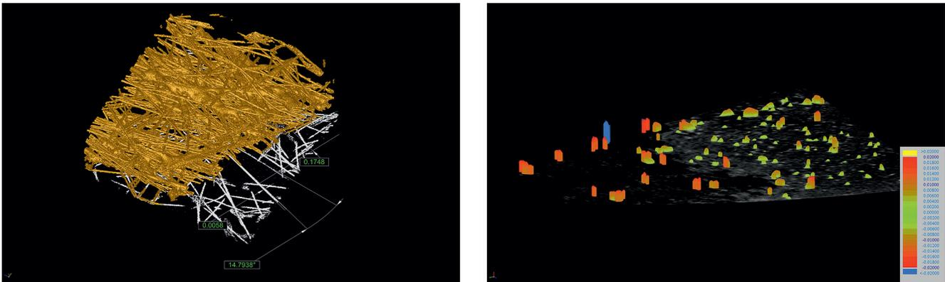
Bild 2. Faserstruktur eines Filters (links) und Eindringtiefe von Partikeln (rechts, Blick aus dem Werkstückinneren auf die Oberfläche) mit Dimensionen im einstelligen Mikrometerbereich © Werth Messtechnik
